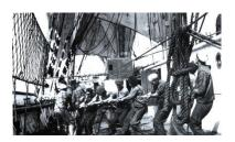
Lors de la manœuvre, le meneur se place en pied de mât avec d'autres matelots et le bosco, ils crochent le plus haut possible dans la drisse et tire sur celle-ci verticalement. Un autre matelot reprend le mou et le tourne autour d'un cabillot (cheville de bois fixé sur la lisse de pavois) pour éviter que la voile ne retombe, c'est le moment de pause, l'effort fourni étant intense. Puis ils crochent de nouveau la drisse et tirent.
